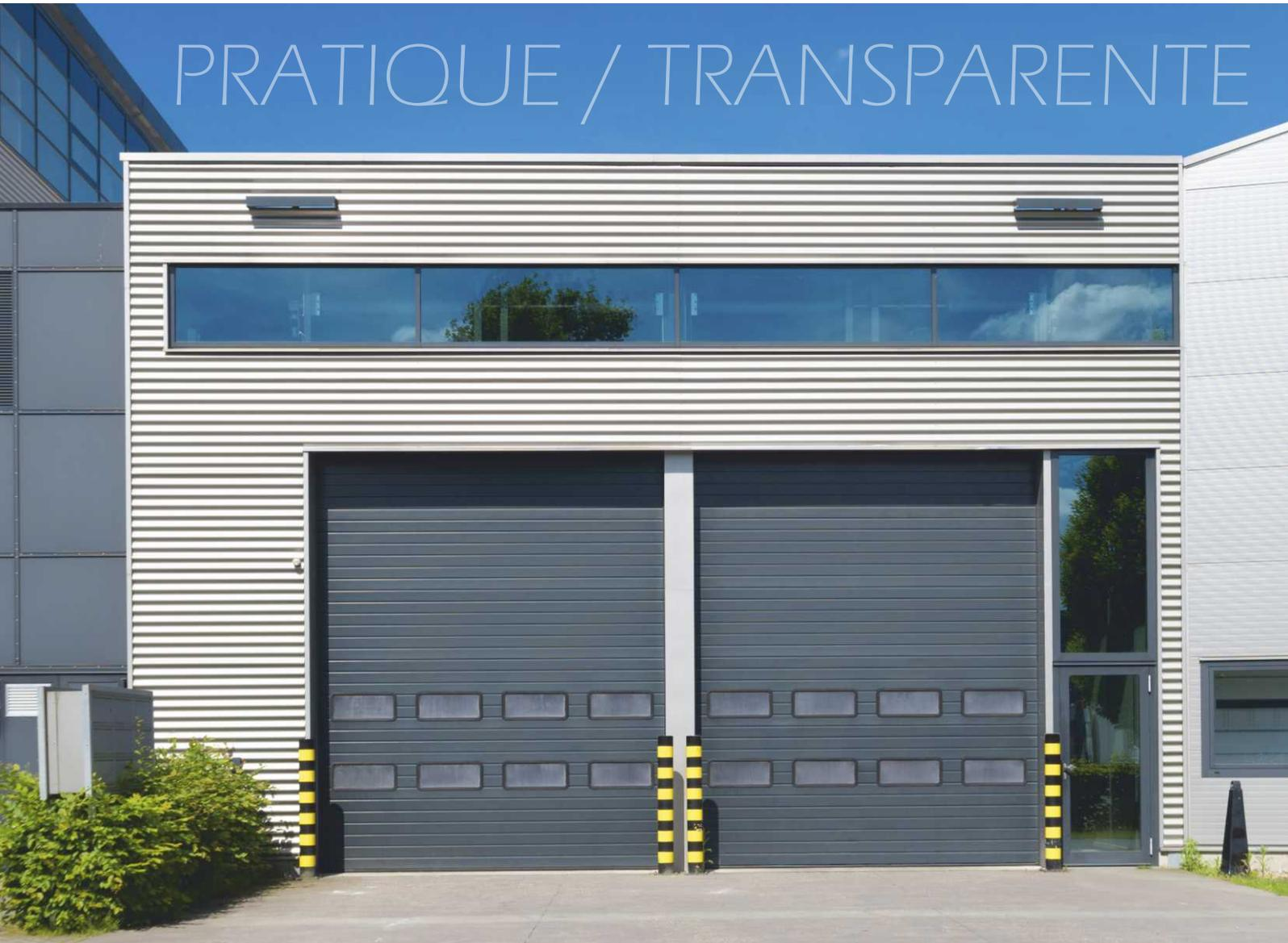
Levant est constituée de panneaux nervurés sandwich double paroi de 40 mm, injectés de mousse polyuréthane sans CFC avec un coefficient d'isolation thermique:  $K=1,4 \text{ W/m}^2\text{k}$ , permettant d'obtenir robustesse et rigidité ainsi qu'une meilleure résistance aux agents atmosphériques. Les joints périphériques et embouts laqués, permettent de réduire les coûts énergétiques. La tôle des panneaux est en acier de 0,5 mm d'épaisseur avec système anti-pince doigts.
